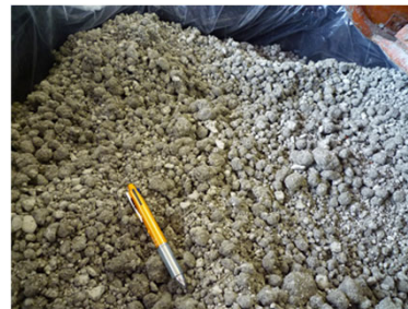
幌延の掘削土(スリ)を用いた埋め戻し材の例
